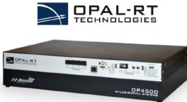
Figura 2.5: Dispositivo RCS de OPAL-RT [13]
